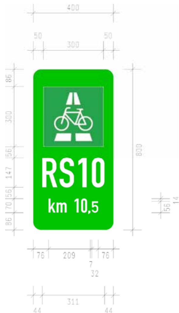
Abbildung 52: Gestaltung der Kilometrierungstafeln
