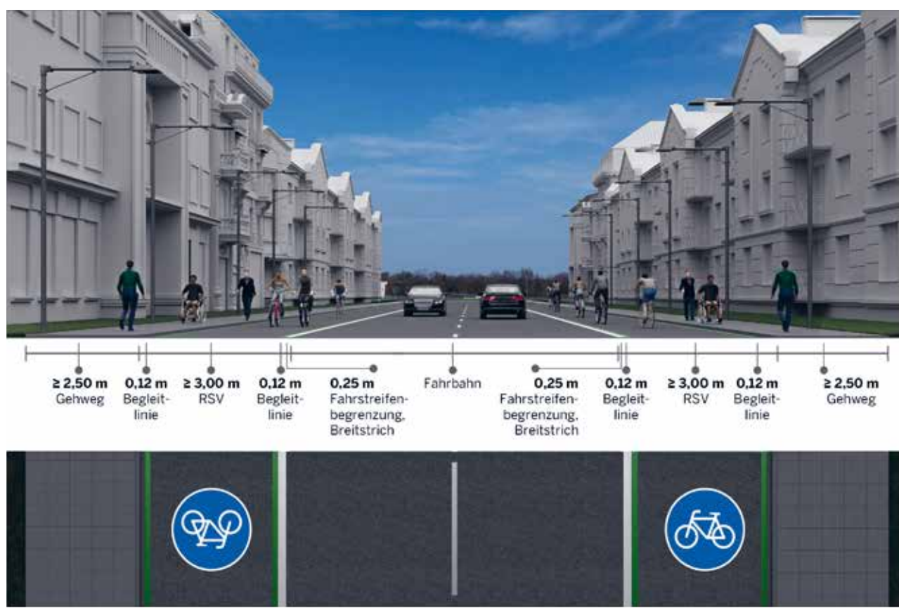
Abbildung 5: Straßenbegleitende RSV als Radfahrstreifen im Einrichtungsverkehr (Skizze)
