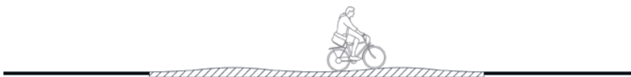
Abbildung 10: Querschnitt einer Sinuswelle (überhöhte Darstellung)
