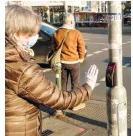
Tritt ein Fußgänger näher an den Taster heran, löst er die Grün-Anforderung aus, ohne den Taster zu berühren.
