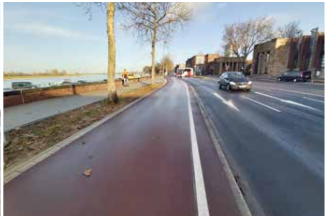
Vorher (linkes Bild): Das Joseph-Beuys-Ufer ist Teil des Nord-Süd-Radweges entlang des Rheins und gehört zum Radhauptnetz. Nachher (rechtes Bild): Der 2,75 m breite, neue Zweirichtungsradweg, in rotem Asphalt, ist nun getrennt vom Gehweg angelegt und schafft mehr Sicherheit und Komfort für den Rad- und Fußverkehr. Entlang der Straße werden als zusätzliche Schutzeinrichtung planmäßig noch Pfosten eingebaut.
