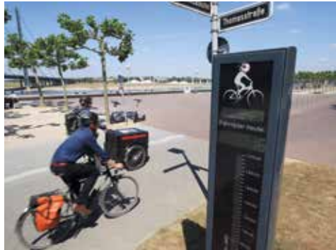
Das Archivbild zeigt die Dauerzählstelle für Radfahrende am Mannesmannufer. Sie ist eine der 13 Zählstellen für den Radverkehr. Vor Ort können die aktuellen Zahlen über eine Infostele abgelesen werden. Archivfoto: David Young
