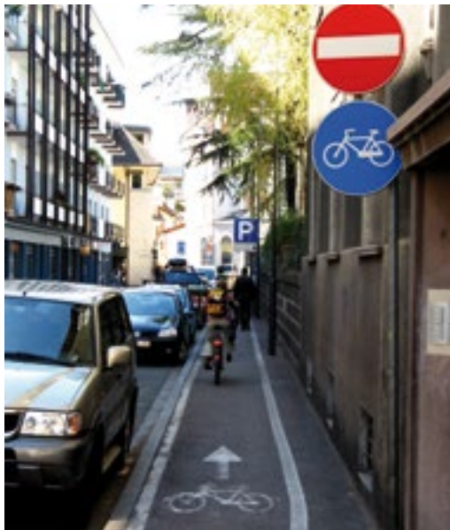
Notlösung: Radweg zulasten des Fußverkehrs
